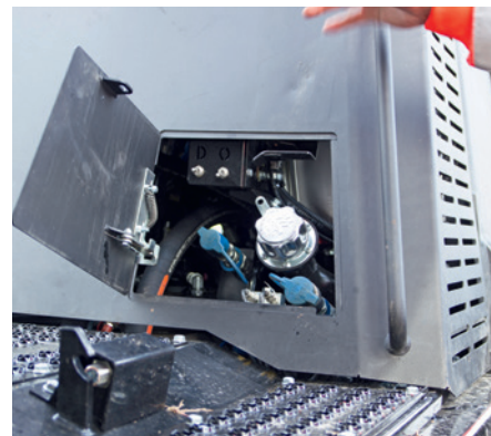
Bränsle och hydraulolja fylls enkelt på stående bredvid maskinen.
