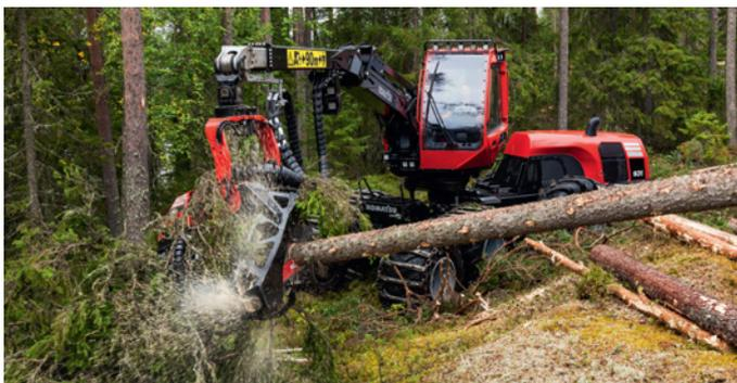
**Mit dem 3-Pumpen-System 3PS kann der Fahrer mehrere Arbeitsschritte gleichzeitig ausführen, da der verfügbare Durchfluss in den Maschinenfunktionen maximiert und angepasst wird.**
