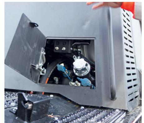
Kraftstoff und Hydrauliköl lassen sich in bequemer Arbeitshöhe vom Boden aus auffüllen.
