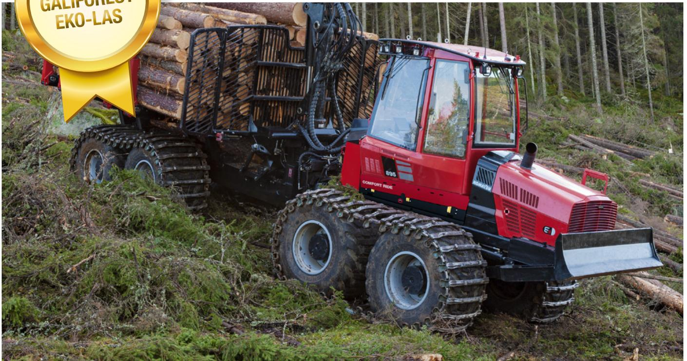
**Federung in jede Richtung. Dank der einzigartigen Konstruktion wird die Kabine beim Fahren in allen Richtungen gedämpft.**
