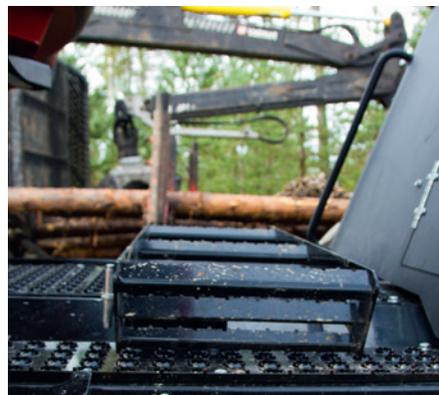
Flexibel einsetzbare Leiter mit Positionssensor.
